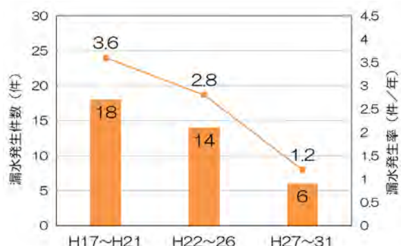
図3.5 地区全体の漏水発生推移（PC管）
