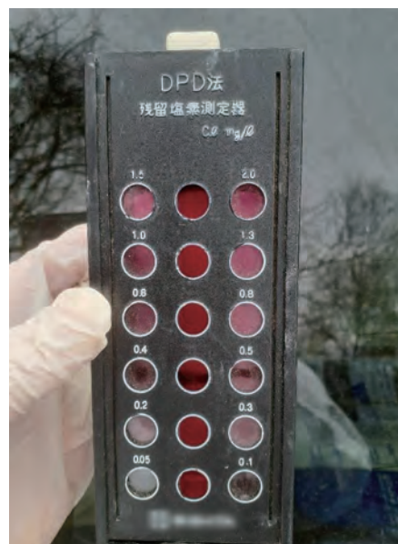
写真：DPD 法（ジエチルパラフェニレンジアミン法） 角型試験管に採水し（左写真）、比色定量により塩素濃度を測定します（右写真）
