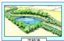
沈砂池により河川への土砂流出を軽減
