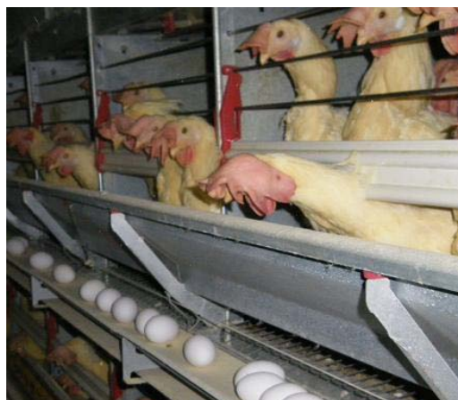
集卵装置を清潔に保ちましょう。また、集卵装置が正常に作動し、卵が放置されていないことを確かめましょう。
