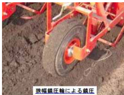
鎮圧しながらの播種作業 (狭幅鎮圧輪により出芽率を向上)
