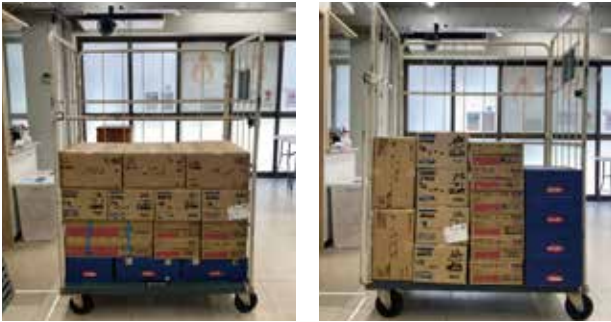
▲左：輸送を目的とした場合。安定性を重視 右：保管を目的とした場合。取り出しやすさを重視
