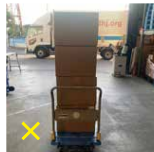
▲使用していない時にも必ずブレーキをオンにする
