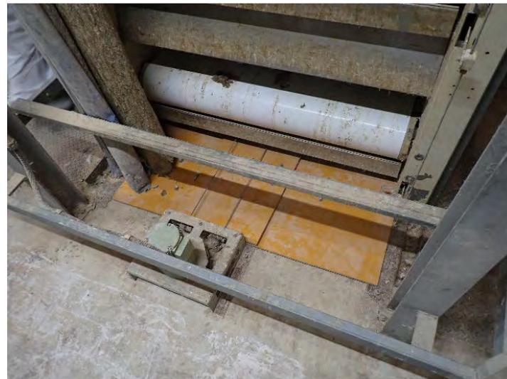
除糞ベルトからこそぎ落とした鶏糞を搬出する床の開口部は、ベルトの運転時以外はコンパネで塞がれている。
