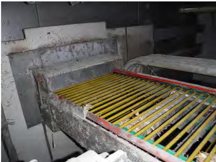
集卵バーコンベアが鶏舎外に出る部分は、集卵作業時以外はほぼ完全に閉鎖されている。
