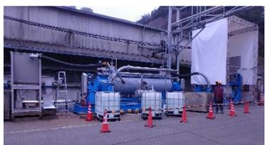
農場で牛・豚の死体を破碎・加熱処理する装置
