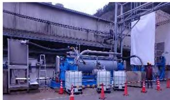
農場で牛・豚の死体を破碎・加熱処理する装置
