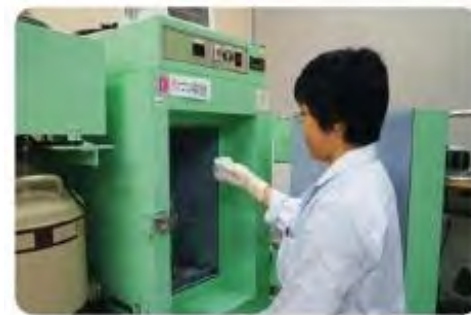
ゲルマニウム半導体検出器による放射性物質検査
