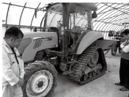
図 3 排水不良圃場での対応力に優れるセミクローラ型トラクター
