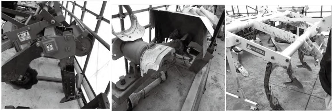
図4 圃場排水改善のための各種装備 (サブソイラ、リターンデッチャー、プラソイラ)
