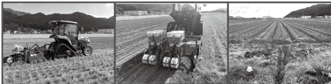
写真3 アップカットロータリーでの畝立て播種作業（左、中央）
