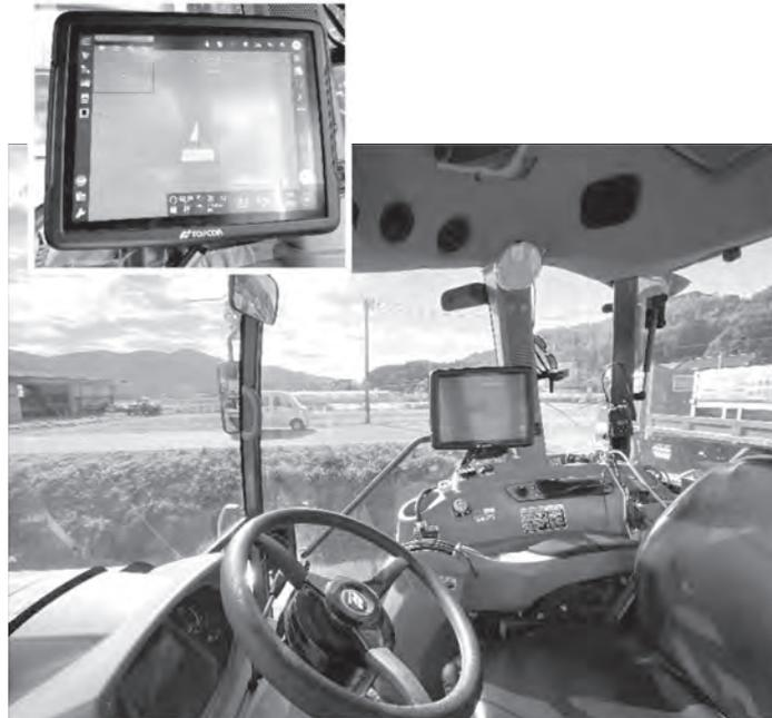
写真4 自動操舵システム付きトラクター
