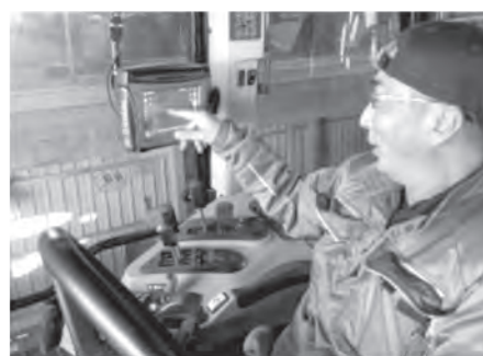
写真2 GNSS 自動操舵装置を搭載
