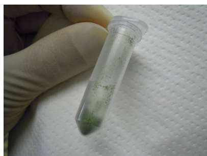
⑨50 mg を 2.0 mL 容チューブに量り採る
