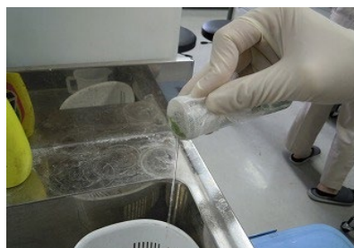
④ガーゼ・水切りネット等を利用し滅菌蒸留水を捨て、3回洗浄する
