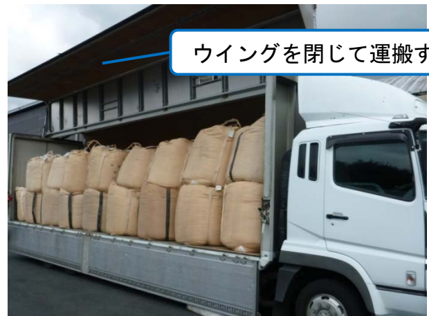
(フレキシブルコンテナバッグをトラックに 積載した状態)
