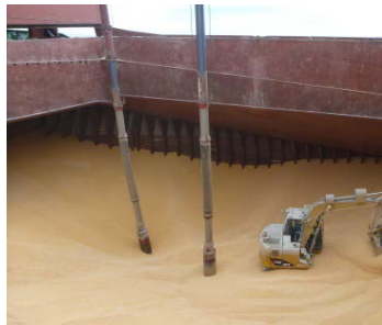
荷揚げの様子
