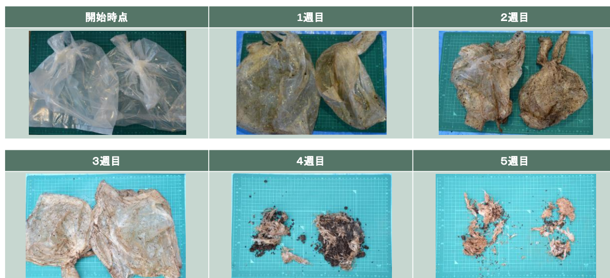
図 1 堆肥化施設における生分解性プラスチック製生ゴミ袋の生分解の様子 (写真は 5 週目までの状況を示す。その後も生分解は進み、最終的に二酸化炭素と水に変換される。)
