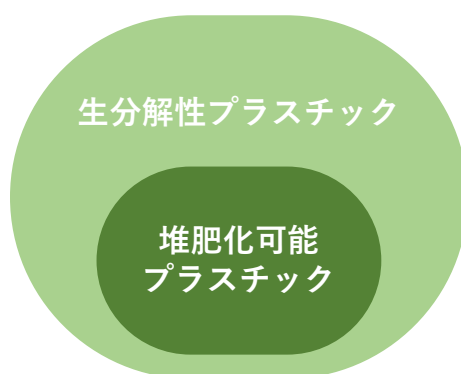
図 3 生分解性プラスチックと堆肥化可能プラスチックの関係
