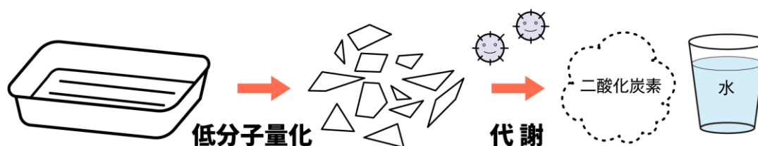
図 2 生分解性プラスチックの生分解の流れ
