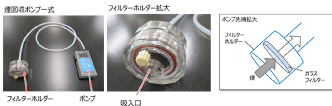
図 2 - 2 燻煙捕集装置
