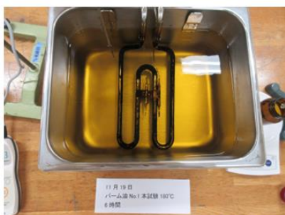
写真 2-23 パーム油 A 180℃ 写真 2-24 パーム油 A 200℃ (上から、未加熱、加熱 30 分後、加熱 3 時間後、加熱 6 時間後)
