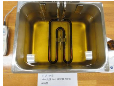
写真 2-23 パーム油 A 180℃ 写真 2-24 パーム油 A 200℃ (上から、未加熱、加熱 30 分後、加熱 3 時間後、加熱 6 時間後)
