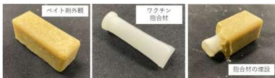
図2-3-5：試作したワクチン抱合材とベイト剤への埋設
