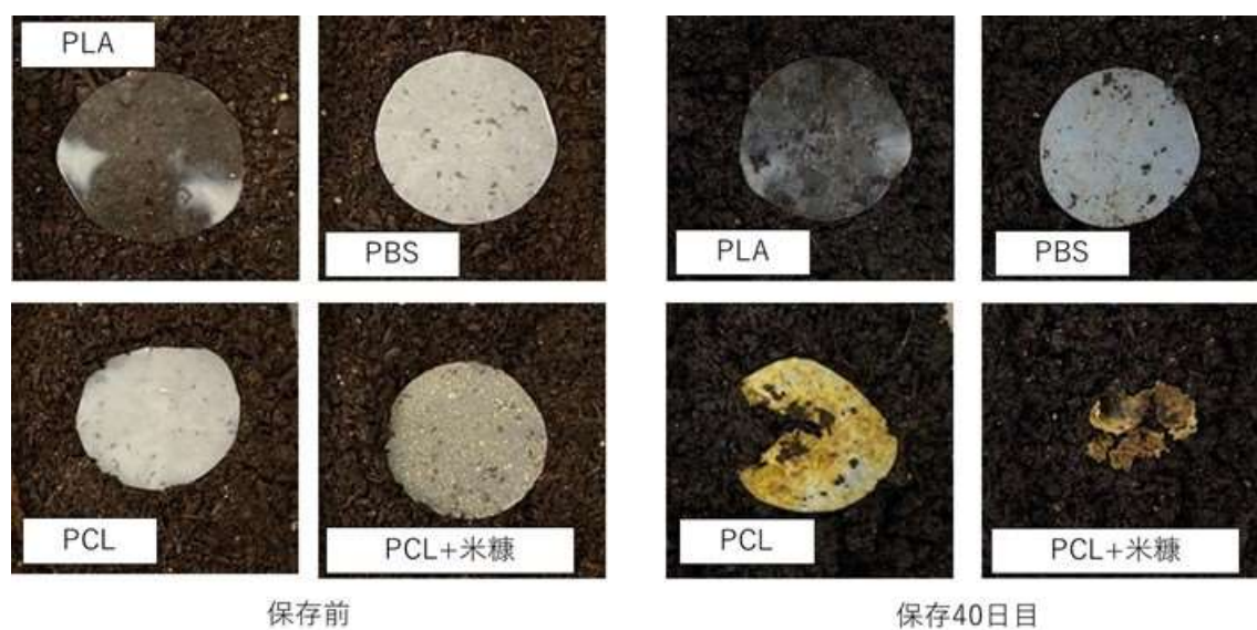
図2-3-4：コンポスト中で保存した生分解性樹脂の外観の変化
