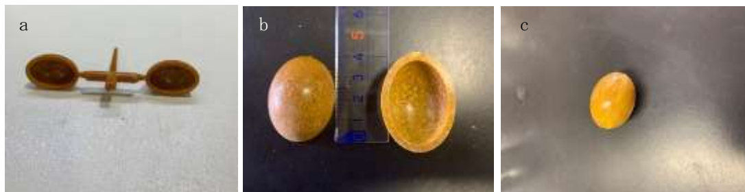
図2-1-7 CGM70%のカプセル材 a:射出成型後, b:外観, c:カプセル化
