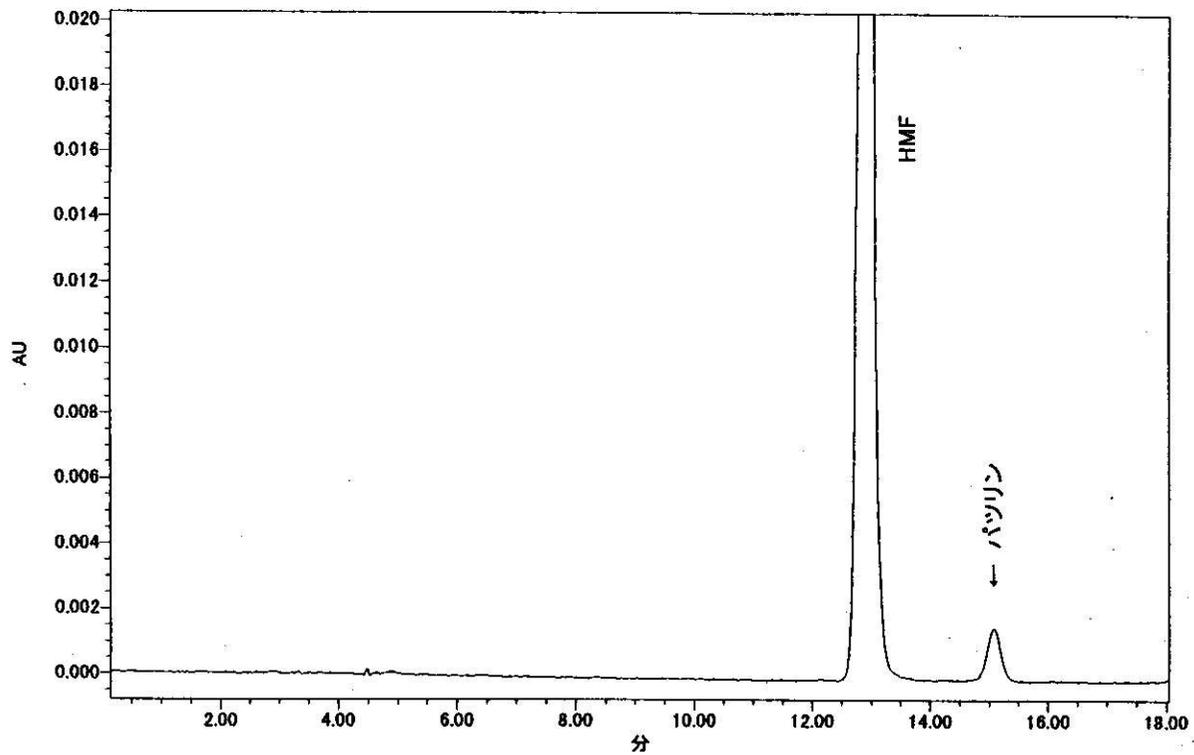
図 2. パツリン・HMF 混合標準液のクロマトグラム (UV 276nm)
