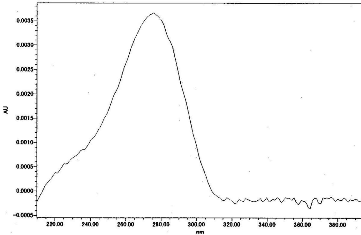
図 6. パツリン標準試料のスペクトル
