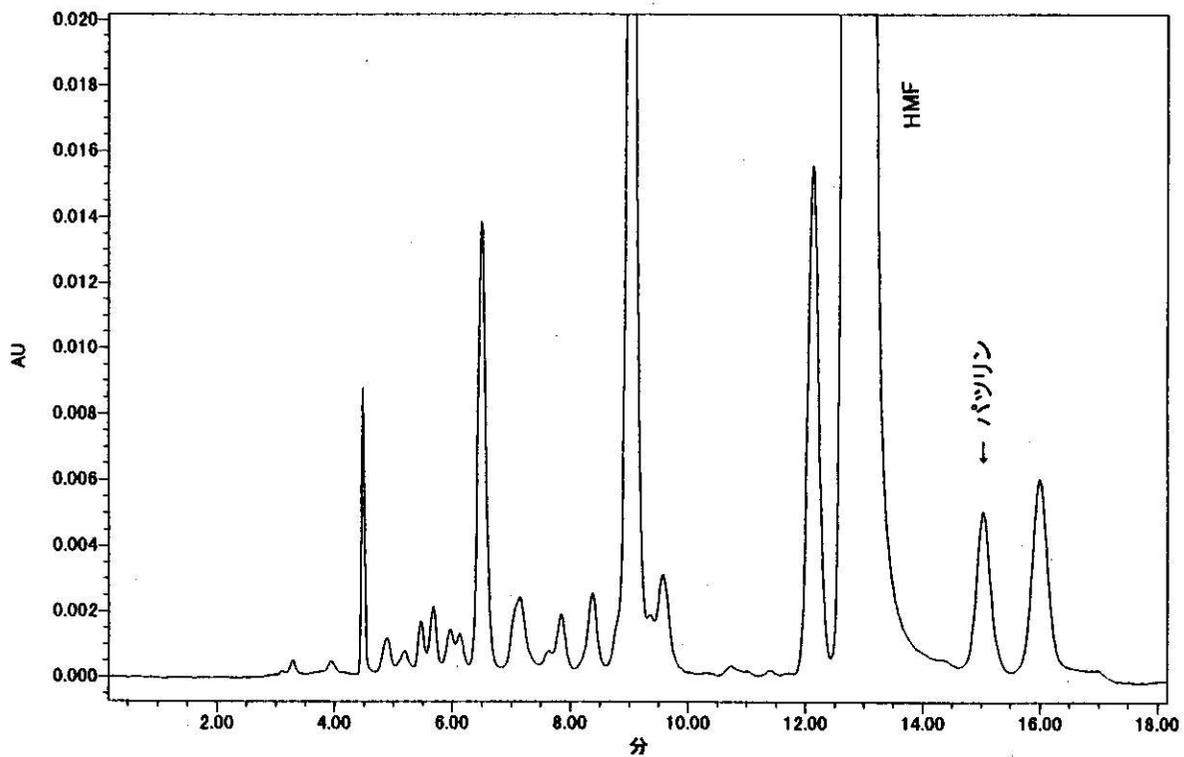
図 3. パツリン検出試料 (#155) のクロマトグラム (UV 276nm)
