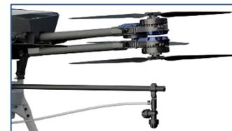
二重反転構造によるダウンウォッシュ効果でドリフトの回避と散布品質の向上を図っています
