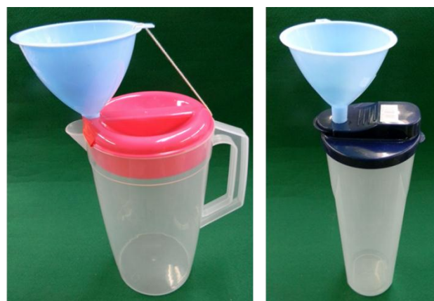
図9 市販容器とじょうごで製作した簡易雨量計 価格は200円程度。右側は撮影で底面積が小さく見えている。
