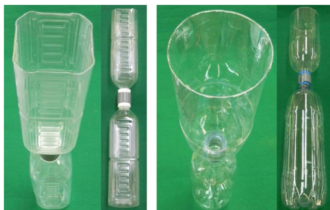
図8 ペットボトルで製作した簡易雨量計 一方容器の底部分を切り取った2個を接合。 左側：900ml容器、右側：2L容器。
