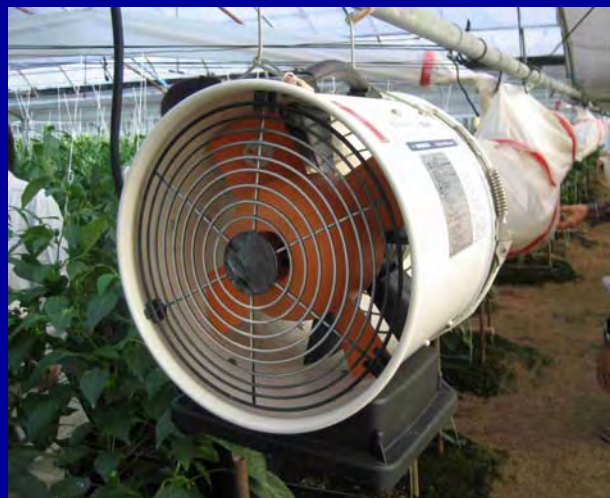
専用ダクトを張って散布する機械(散布機機)
