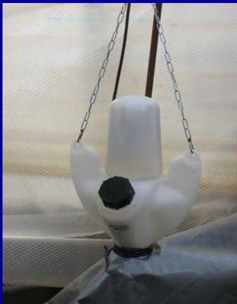
自動で暖房ダクトに投入する機械(投入機)
