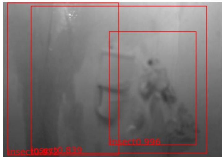
図 14. 背景の色ムラを誤検知した様子
