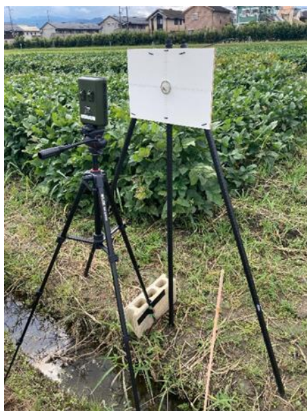
図3. フェロモン剤（白板の中央部に配置）に誘引された害虫を熱センサー搭載の自動撮影カメラで撮影する装置
