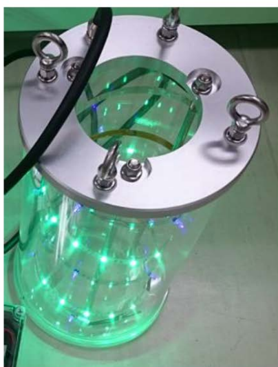
H28年度試作の内外透明アクリルの2色ハイブリッド光源
