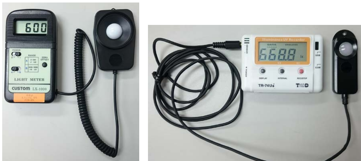
図 3 使用した照度計（左：照度計 LX-1000、右：照度計 TR-74Ui）。表示部がある本体と、コードで接続されたセンサ部で構成され、センサ部の丸く白い検出部に当たった光の強さ（照度）が計測される。同様の照度計は多数販売されている。
