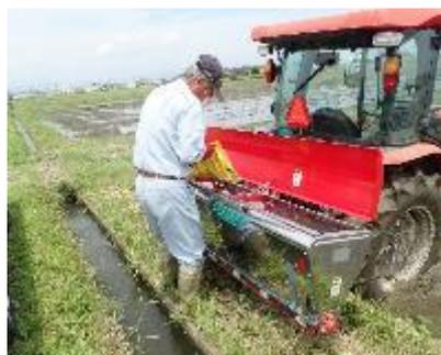
図 6-2 ライムソーを用いた石灰窒素の散布
