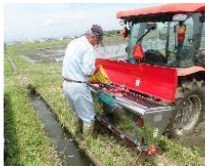
図 6-2 ライムソワーを用いた石灰窒素の散布
