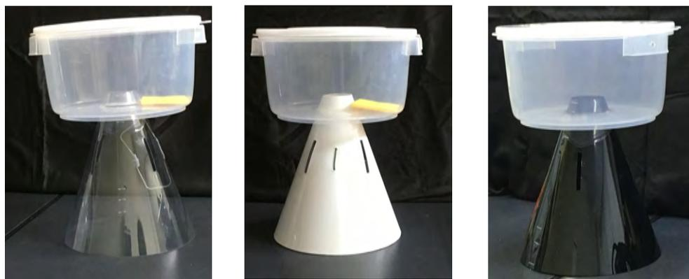
図1 試験に使用したトラップ（左から透明コーン、白色コーン、黒色コーントラップ）
