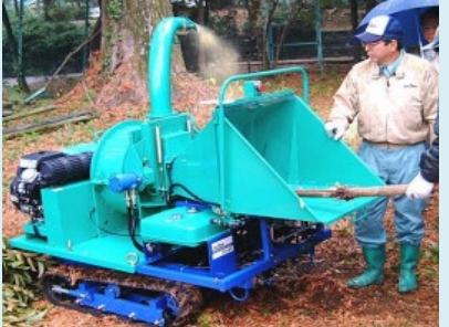
移動式チッパー (森林病虫害等防除活動支援体制整備促進：資器材の整備)
