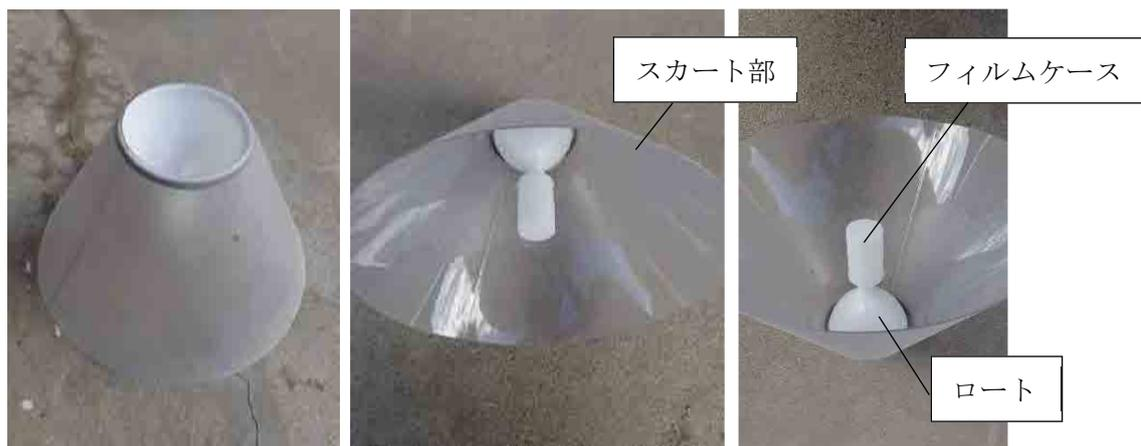
図3 ロート型トラップのロート部分
