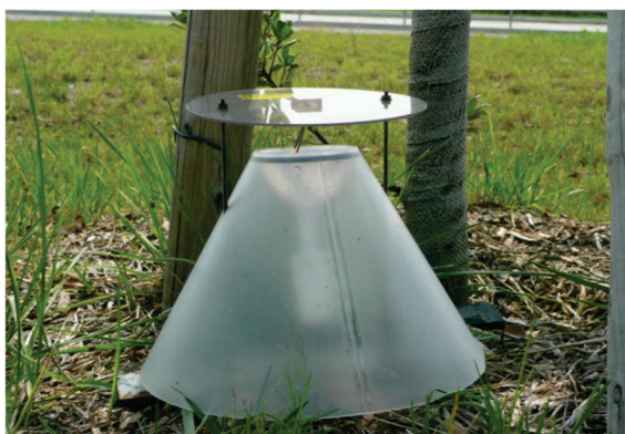
図1 ロート型トラップ
