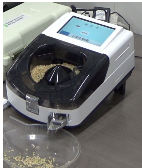
図17 穀粒判別器を用いた玄米品位の計測
