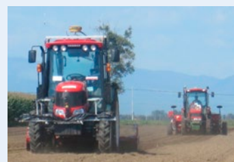
無人機と有人機の協調作業システム (無人機による耕起(左)、 有人機による施肥播種(右))
