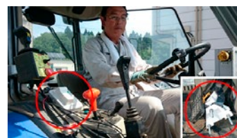
旧型トラクターに 後付けしたセンサー機器
