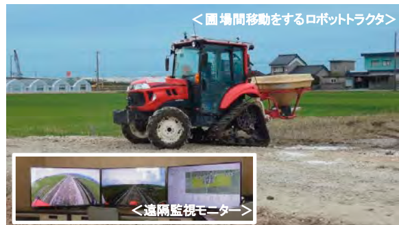
圃場間の移動を含む遠隔監視下での自動走行システム(実演)
