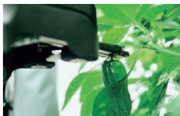
スタートアップによるピーマン自動収穫ロボットの開発
