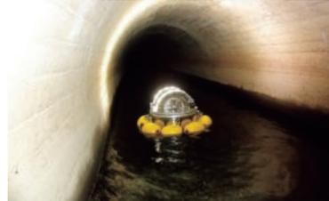
点検ロボットによる通水中の水路トンネルの点検
