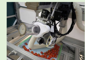
ミニトマトの吸引型自動収穫ロボット
