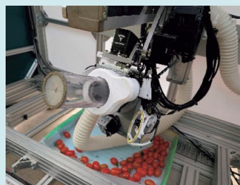
ミニトマトの吸引型自動収穫ロボット
