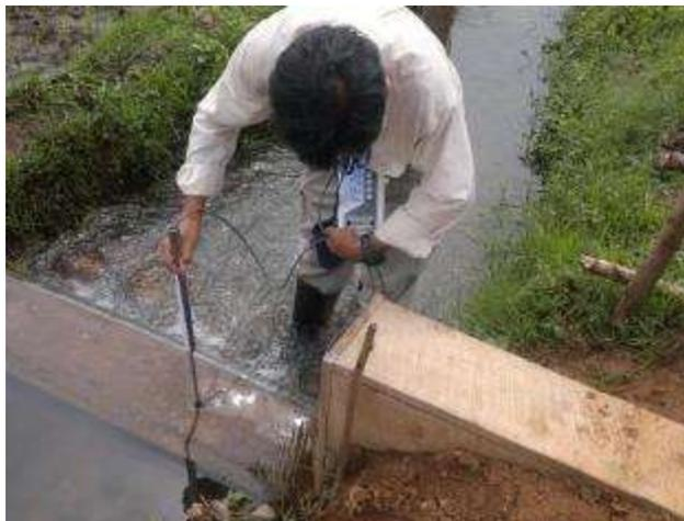
地下水位もロガーで自動計測
