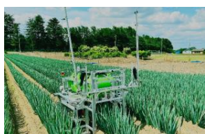
ネギの自動農薬散布ロボットの開発
