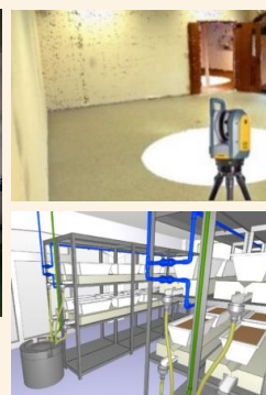
空間を3Dスキャンし（上）、3Dで設備図面を作成（下）
