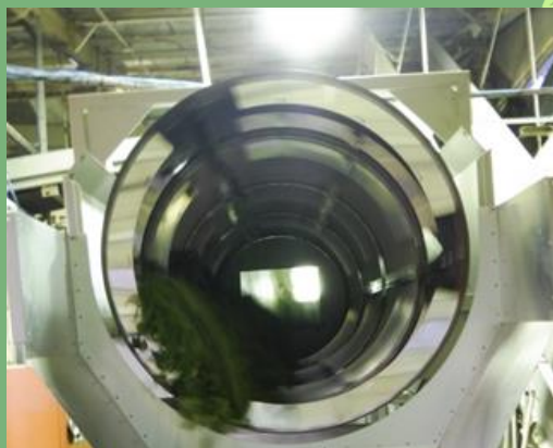
揺青機で、茶の生葉を攪拌し適度な物理ストレスを与えます。 画像提供：静岡県農林技術研究所茶業研究センター
