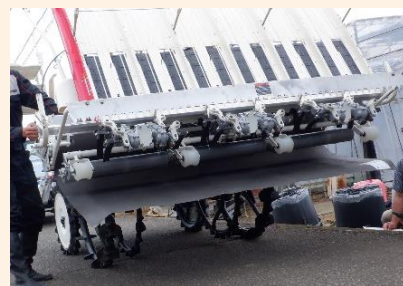
▲セットする再生紙ロールは長さ170m、幅1.9m、重さ23kg
