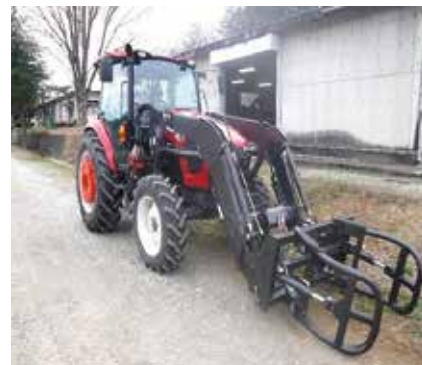
バールグラブを装着してロール状の飼料などを運びます。
