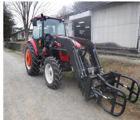
ベールグラブを装着してロール状の飼料などを運びます。
