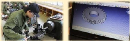
機械加工(旋盤) CADによる製図
